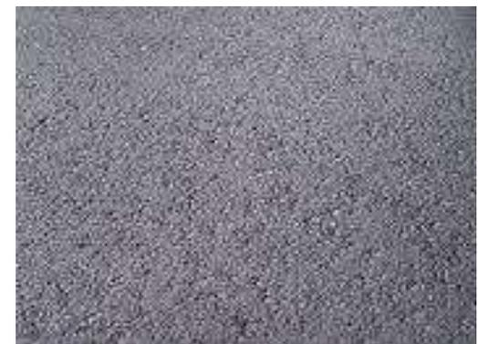
Granitsplitt als Zuschlagsstoff für die Aufhellung der Asphaltdeckschicht
