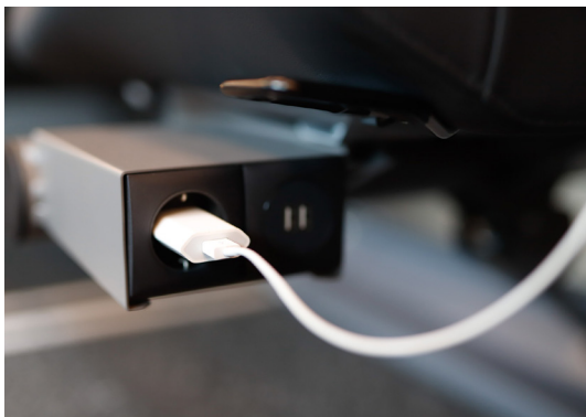
Zu einer modernen Ausstattung zählen auch Steckdosen am Platz, hier im Zug Siemens Desiro HC der ODEG (Quelle: ODEG – Ostdeutsche Eisenbahn GmbH)
