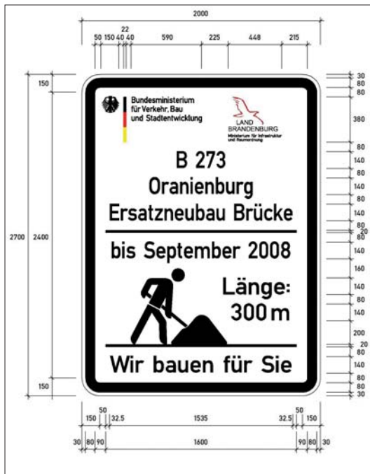
Abbildung 8: Beispiel Baustellenbeschilderung Anfang der Baustelle (Bundesstraße)
