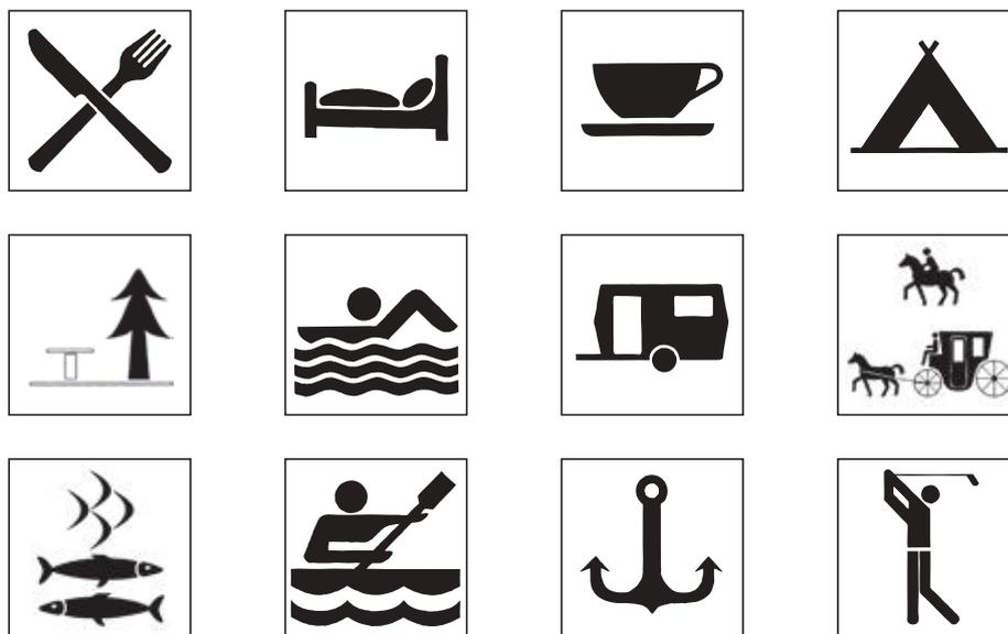
Abb. 2.47: Zulässige Piktogramme für die Objektwegweisung für den Kfz-Verkehr
