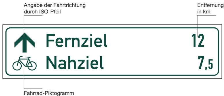
Abb. 2.2: Inhalte eines Zielwegweisers
