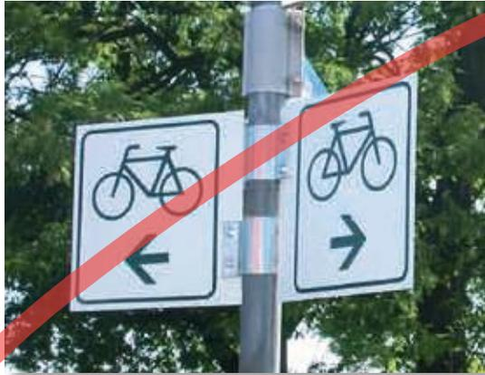
Abb. 2.36: Unzulässige Montage eines Zwischenwegweisers als Fahnenwegweiser
