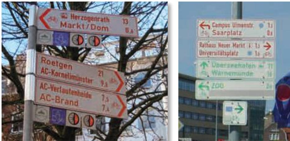
Abb. 2.13: Im Land Brandenburg ist für die Radverkehrswegweisung die Farbe Grün, in Nordrhein-Westfalen die Farbe Rot zulässig, in Rostock hingegen werden beide Farben verwendet
