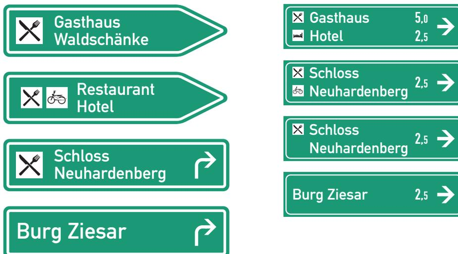
Abb. 2.46: Objektwegweisung für den Kfz-Verkehr (links) und für den Radverkehr (rechts)
