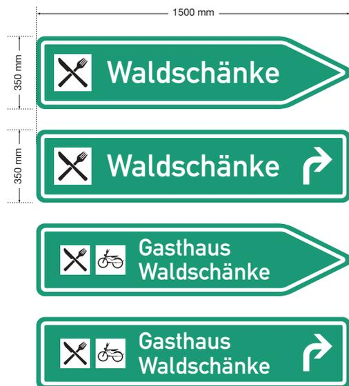
Abb. 2.49: Gestaltung der Objektwegweiser für den Kfz-Verkehr
