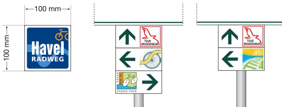
Abb. 2.17: Standardmäßige Größengestaltung der Routenlogos (links), Routenwegweisung für Tabellenwegweiser (rechts)
