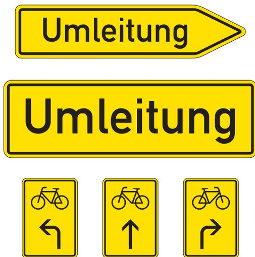
Abb. 2.59: Ausweisung von Umleitungen
