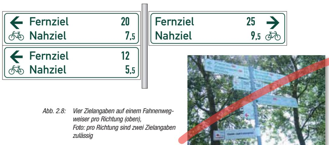
Abb. 2.8: Vier Zielangaben auf einem Fahnenwegweiser pro Richtung (oben), Foto: pro Richtung sind zwei Zielangaben zulässig
