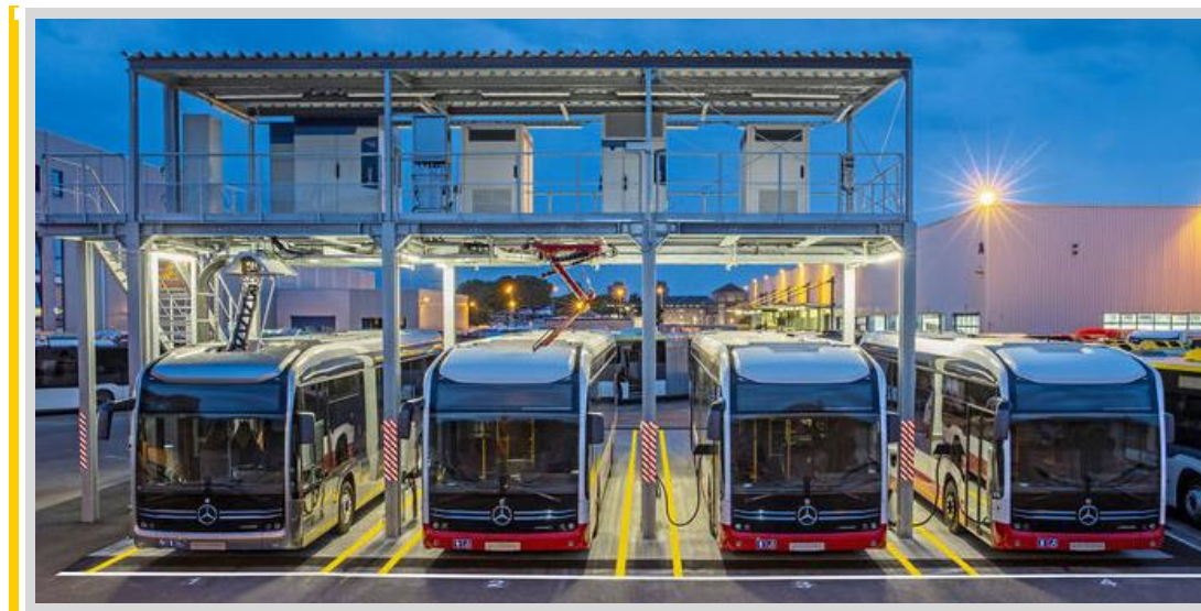
Abbildung 2.18: Stationäre Energiezuführung [Daimler]
