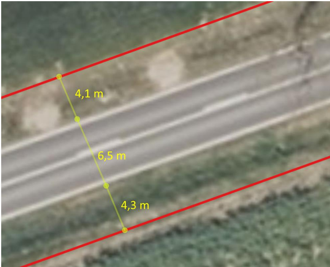
Abbildung 102: GIS-basierte Messung der Flurstücksbreiten neben dem Fahrbahnrand; rot = Flurstücksgrenzen, gelb = Abstandsmaße ellipsoidal berechnet, hier: L26 zwischen Carmzow und Brüssow mit Fahrbahnbreite von 6,50 m und Flurstücksbreiten von 4,10 m und 4,30 m.
