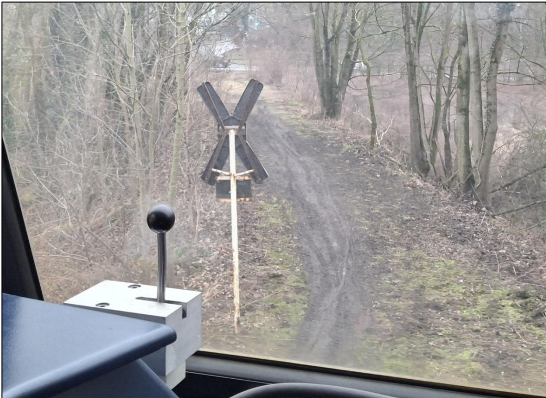
Abbildung 24: mit einem Andreaskreuz gesicherter Bahnübergang Schwarzer Weg aus der Führerstandsperspektive
