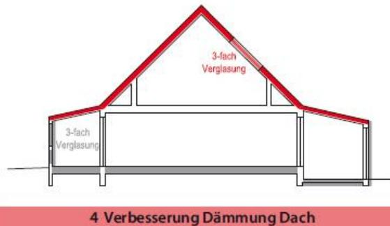
Abb. 2.3.62: Vierter Sanierungsschritt, schematische Darstellung
